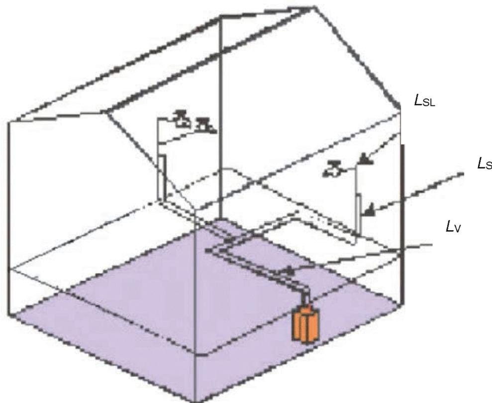
Рисунок Г.1 — Расположение трубопроводов
