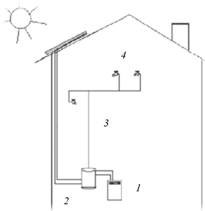
1 – водонагреватель; 2 – накопитель; 3 – система распределения; 4 – водоразбор
