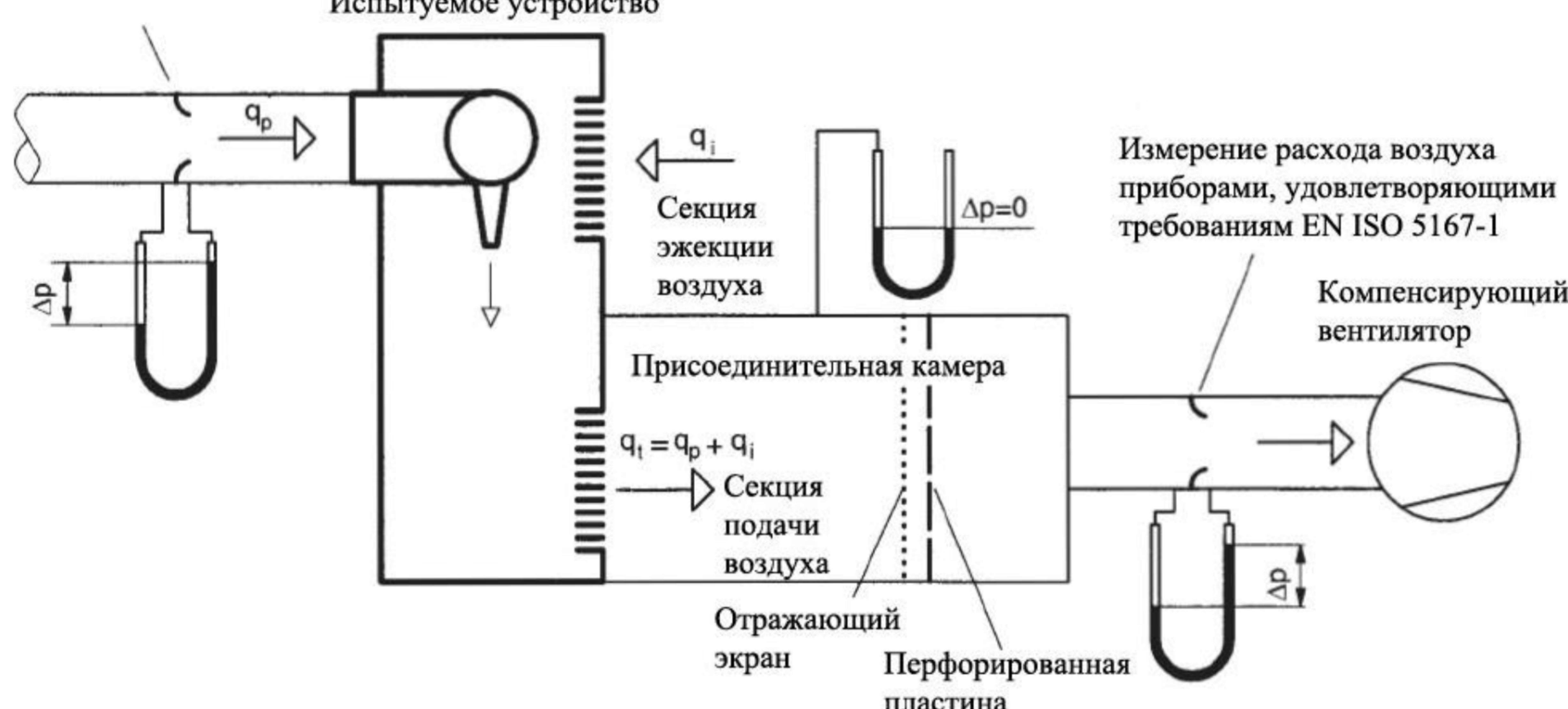
Рисунок 3 - Испытательная установка для измерения коэффициента эжекции методом нулевой разности давления
