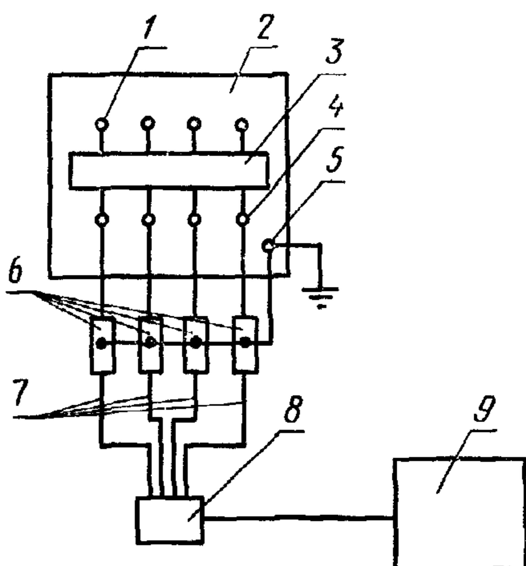
**42 Расположение аппаратуры и оборудования при измерениях напряженности поля радиопомех, создаваемых малогабаритными электроустройствами**
